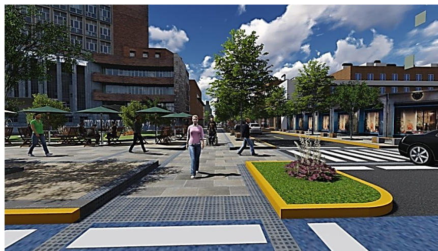
Imagen 29: pavimento podotáctil de advertencia marcando el límite de la franja de circulación peatonal, con la del tráfico rodado. Cuando existe un cruce, se colocan tres filas de adoquines seguidos. También se puede apreciar el cruce a nivel a lo largo de toda la calzada, de tal manera que se lo pueda hacer fácilmente en silla de ruedas o con movilidad reducida.
