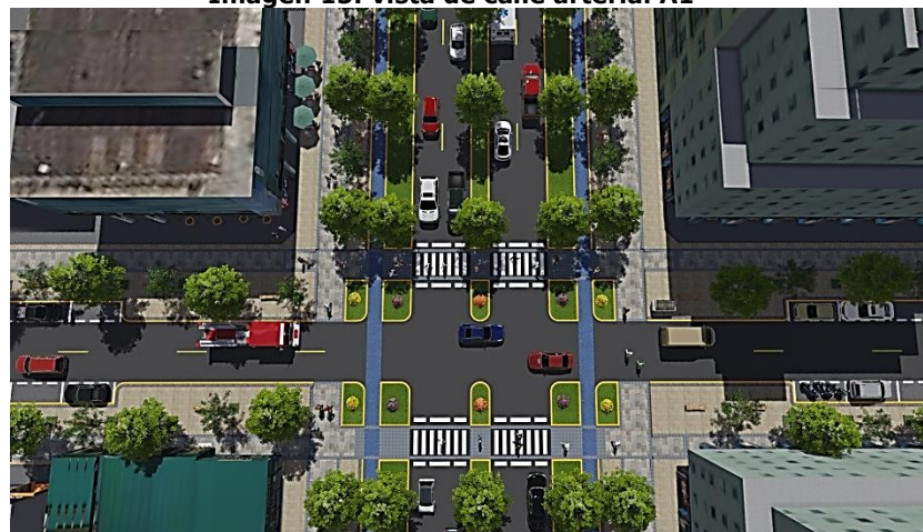
Imagen 16: intersección entre colectora y local
